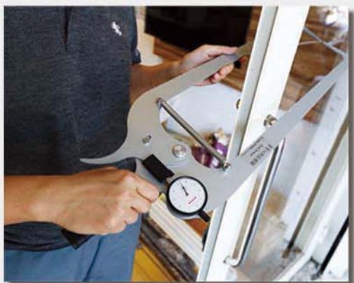
透過這台要價七十幾萬元的手持式掃描機，可以立即檢測出烤漆的厚度。
